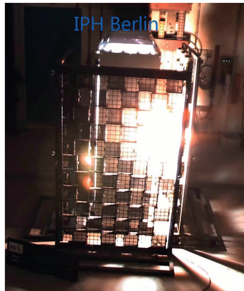
VAMOCON-Anlage bei Prüfungen unter Störlichtbogenbedingungen
